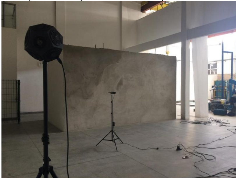
Figura 01: Protótipo de construção com Isobloco no qual foram realizadas as medidas
