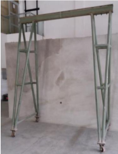
Figura 3 – Ensaio de corpo duro na parede externa (PE)
