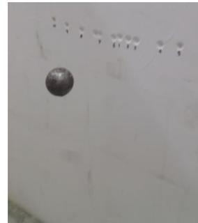
Figura 6 – Mossas resultantes do ensaio na parede interna (PI)
