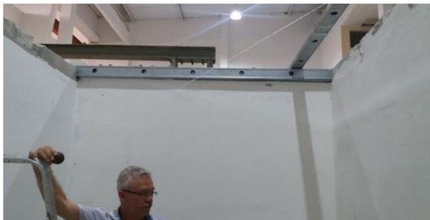
Figura 5 – Ensaio de corpo duro em parede interna (PI)
