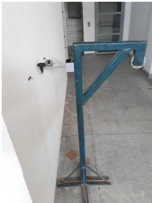
Figura 5 – Sistema de medição de deslocamentos horizontais
