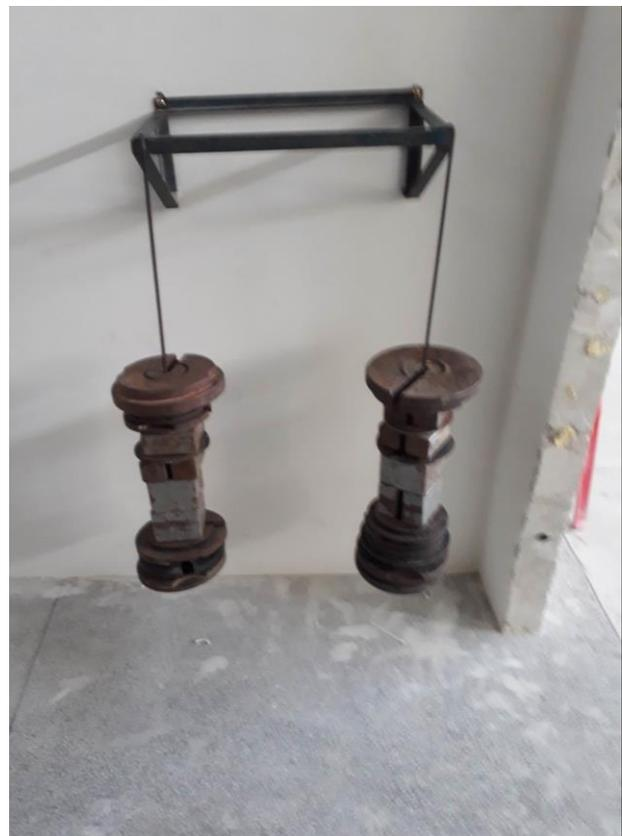
Figura 4 – Ensaio na parede interna - PI
