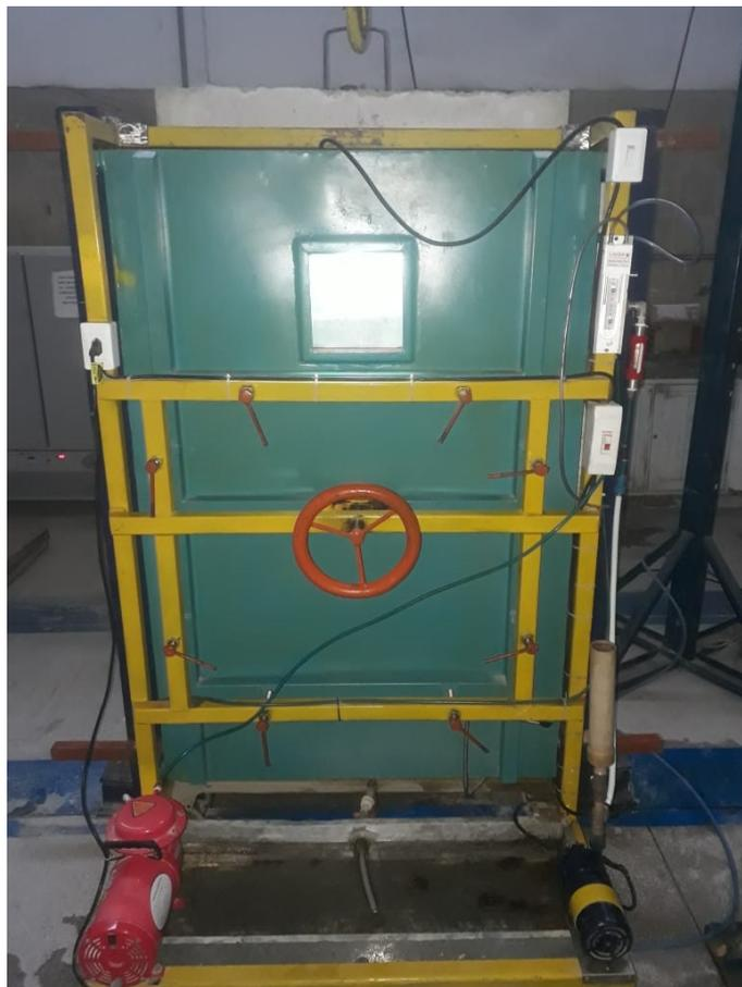
Ao final do ensaio, mediu-se a porcentagem da área da mancha de umidade na face oposta à incidência da água sob pressão, em relação à área total da face interna, que é de 7200 cm<sup>2</sup> (80 cm de largura x 90 cm de altura). Considerando-se uma edificação térrea, essa porcentagem deve ser menor ou igual a 10% e para edificação com mais de um pavimento, esta porcentagem é de 5%.
