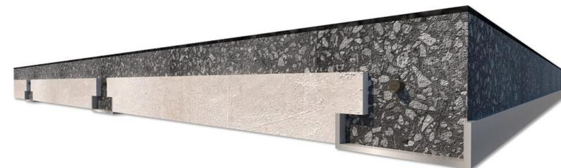
O Sistema Isolaje Forro Armada é usado em substituição à laje convencional para forro e telhado. É montada com nervuras treliçadas. É aplicada conforme melhor detalhado no guia prático de montagem.
