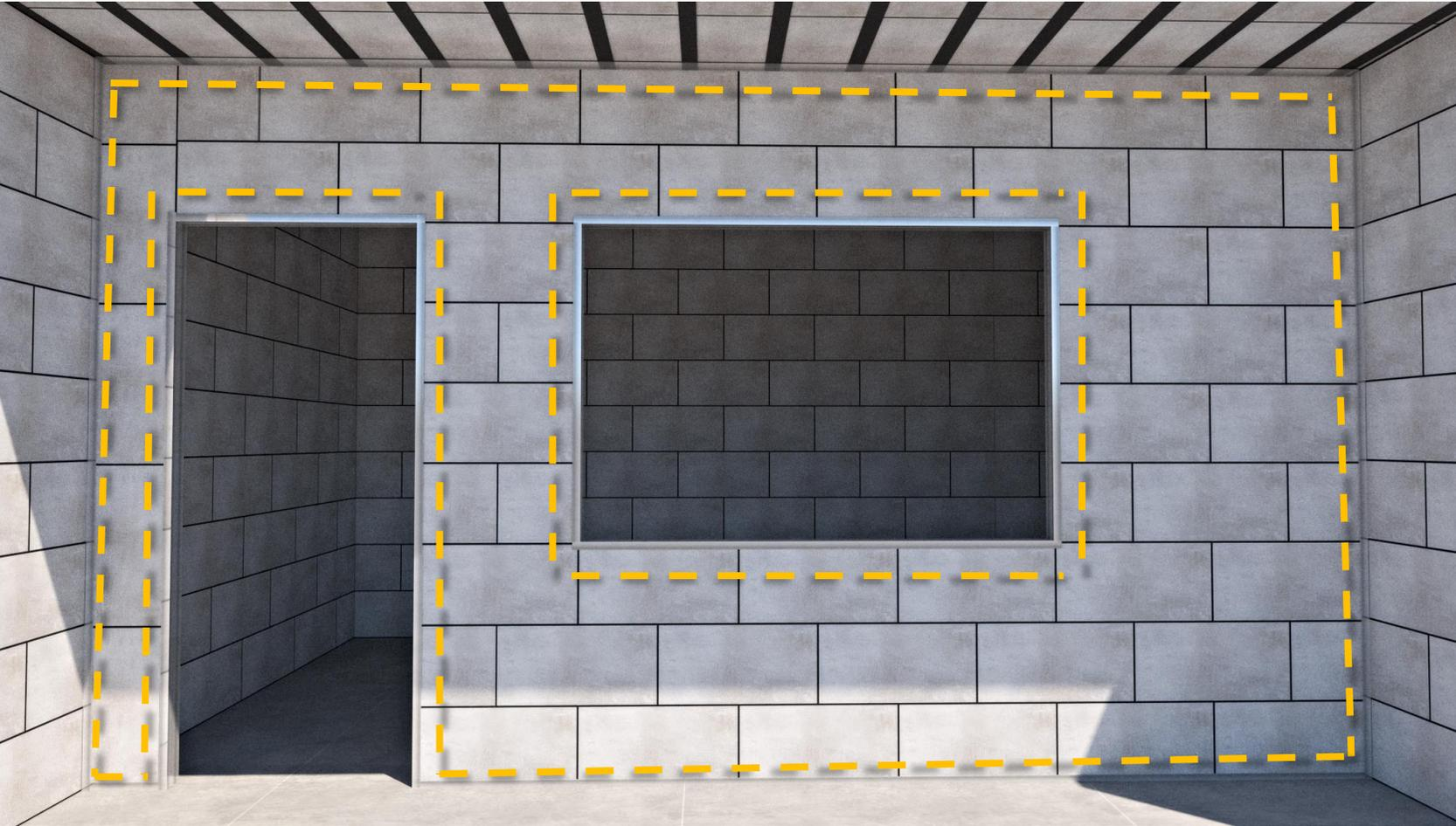
As paredes divisórias em sistema Isoflex (7x30x60)cm devem ser estruturadas com guias 'U' LSF 70mm.
