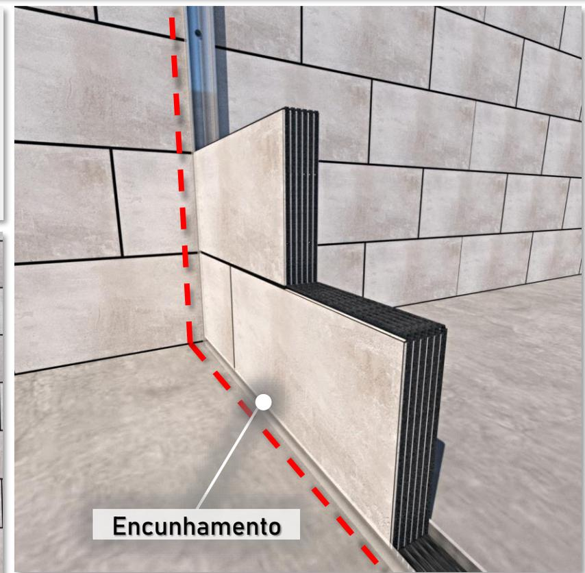
Caso seja necessário realizar encunhamento, você pode utilizar tanto espuma PU como isopor 5mm.
