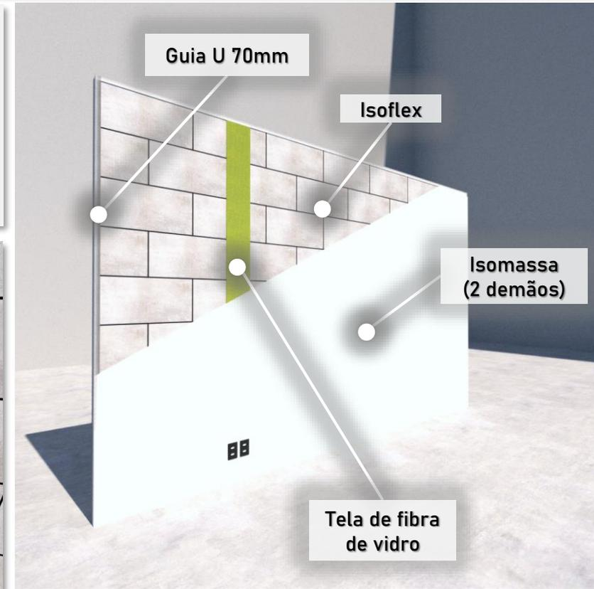
Porém onde houver tratamento de junta, faz-se necessária a aplicação de tela de fibra de vidro a fim de evitar patologias, como rachaduras, devido às movimentações mecânicas naturais do sistema.
