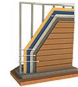
Light Steel Frame (com lâ de vidro)
