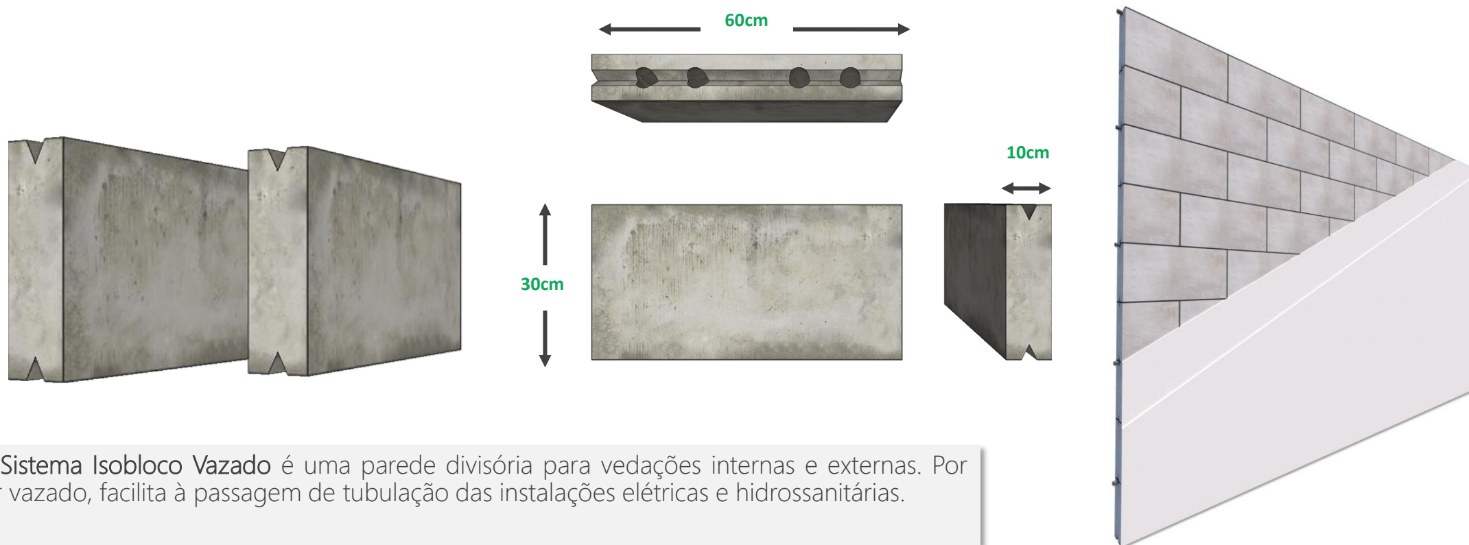
FICHA TÉCNICA SISTEMA ISOBLOCO VAZADO (10x30x60)cm
